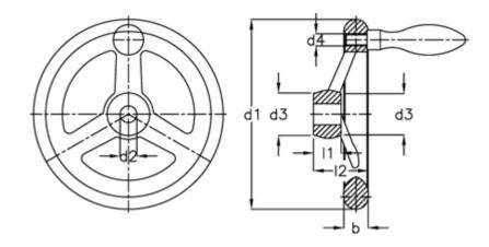
b = 26 d1 = 250 d2 H7 = 26 d3 = 45 d4 = M 12 Handle  $\overline{\phantom{a}}$  = 32 l1 = 28 l2 = 50
